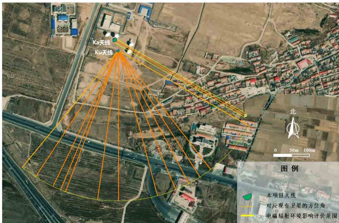
图 3.1-2 本项目卫星天线对应现有在轨卫星的发射方向分布 (6) 总平面布置
